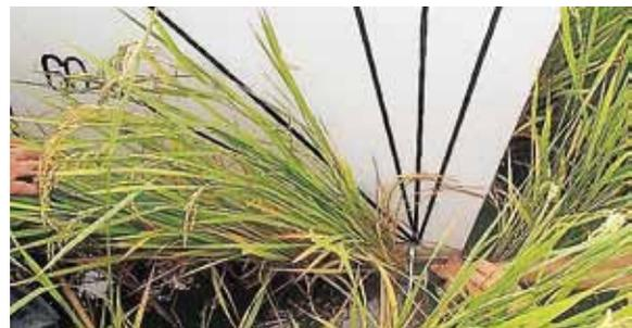
図2 倒伏試験器(大起理化工業)を用いた押し抵抗値の測定
